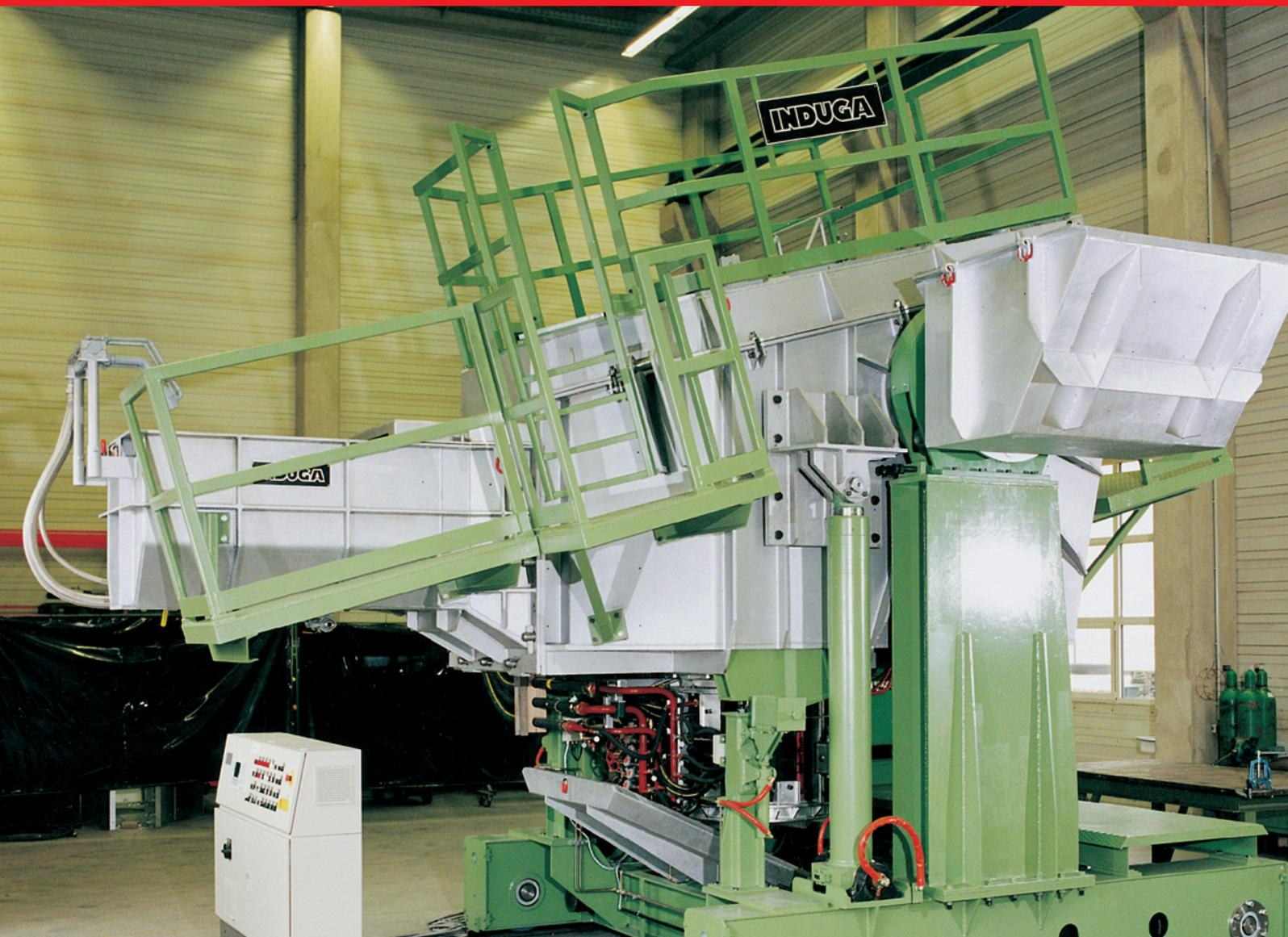
Um die verfahrenstechnischen Vorteile des Vorherdgießofens auch beim Gießen von verschiedenen Kupferlegierungen nutzen zu können, bietet INDUGA diesen Ofentyp auch mit aufgeflanschem Tiegelinduktor an. Daraus resultiert eine hohe Flexibilität beim Legierungswechsel und ein stabiler Betrieb selbst bei ansonsten problematischen Legierungen.
