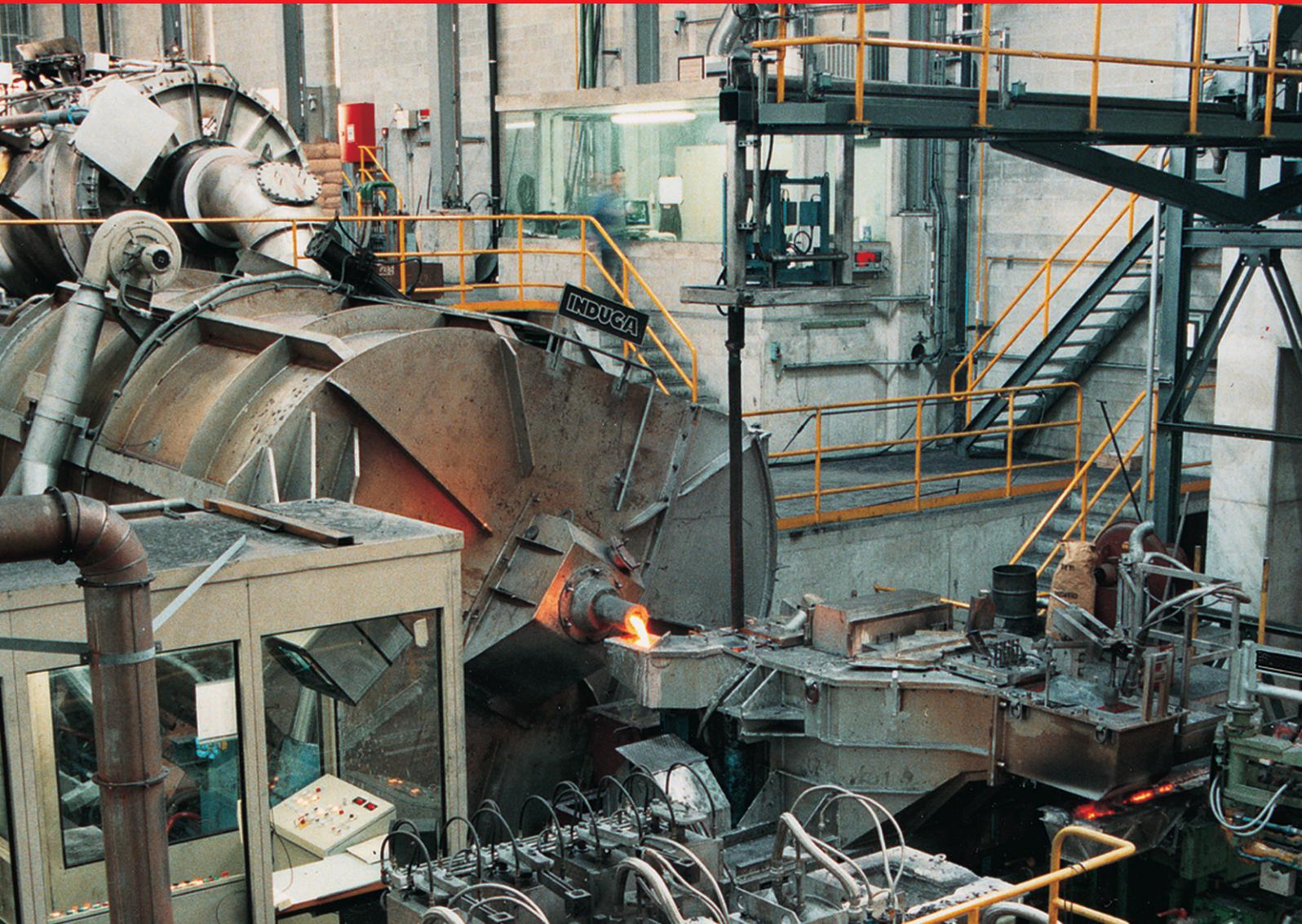
Der induktiv beheizte Legierungs- und Dosierofen ist eine Alternative zum konventionellen nicht beheizten Gießtundish. Zum Beispiel bei der Herstellung von phosphordesoxidiertem DHP-Kupfer kommt es auf präzise Phosphordosierung, gute Durchmischung und vollständige Homogenisierung an.
